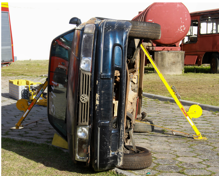
Figura 11 - Estabilização de veículo lateralizado sobre a lateral da roda.
