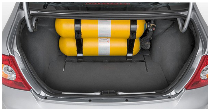
Figura 8 - Cilindro GNV instalado
