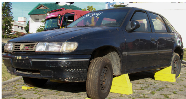
Figura 10 - Estabilização de veículo sobre quatro rodas com calços.
