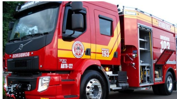
Figura 16 - Viatura com bombas de incêndio acopla-
