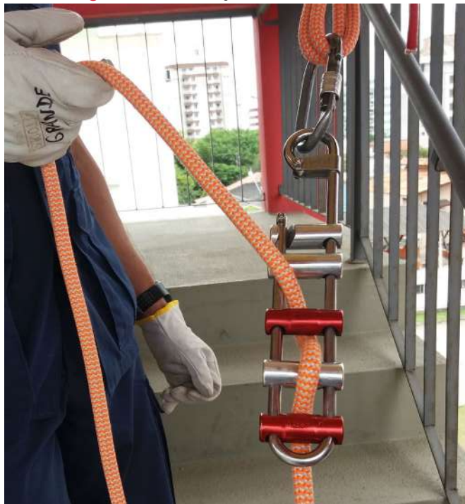
Figura 48. Colocação da corda no rack
