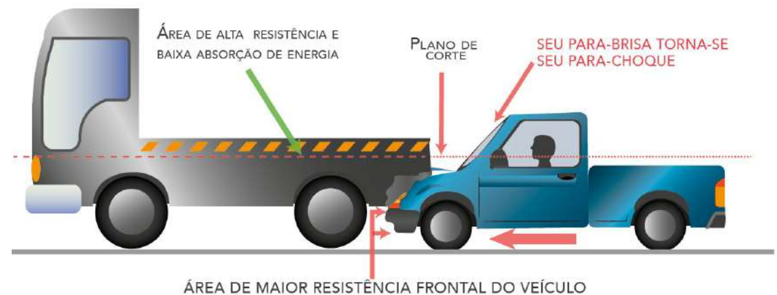
Figura 9 - Esquema do efeito guilhotina
