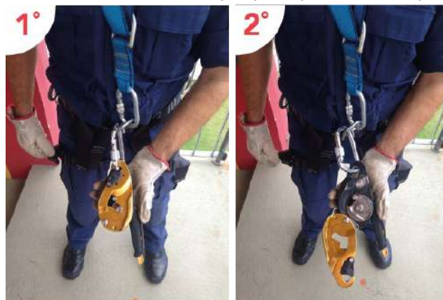
Figura 26. Sistema de back up e principal, este com prussik
