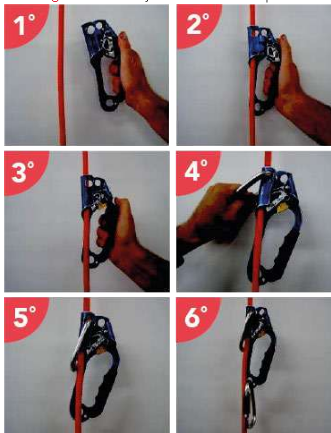
Figura 2. Instalação do ascensor de punho
