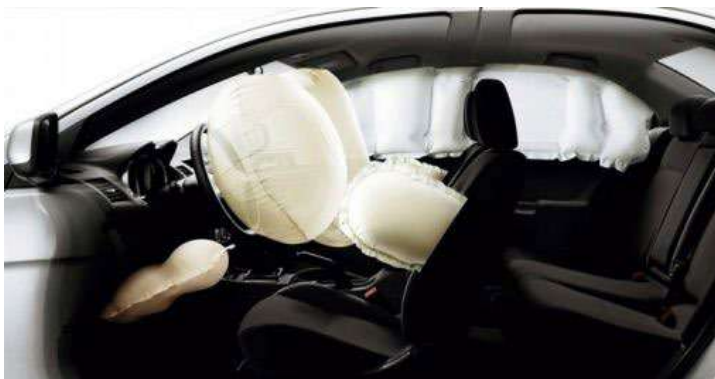
Figura 3 - Possíveis posicionamentos dos airbags
