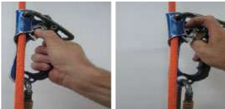
Figura 6. liberação do ascensor de punho para a descida
