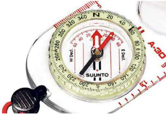
Figura 3 - Detalhe da agulha e limbo da bússola
