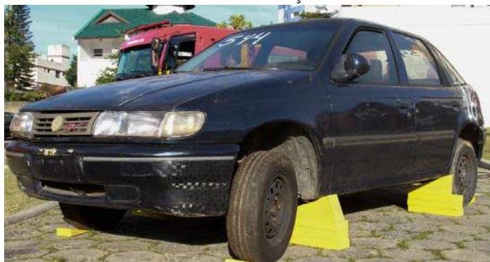
Figura 10 - Estabilização de veículo sobre quatro rodas com calços.
