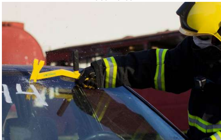
Figura 3 - Fragmentos lançados no ar durante a quebra dos vidros
