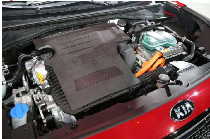
Figura 10 - Identificação dos cabos em veículos híbridos
