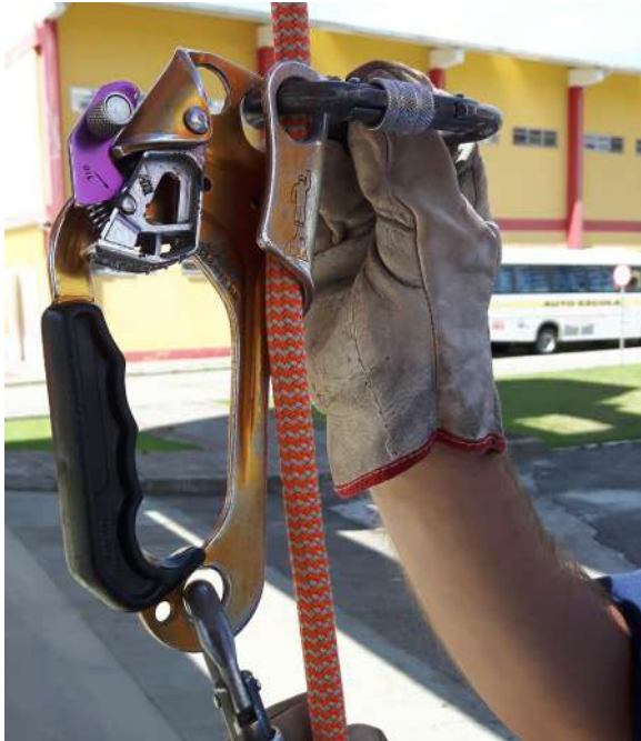
Figura 5. Montagem do ascensor superior com trava aberta
