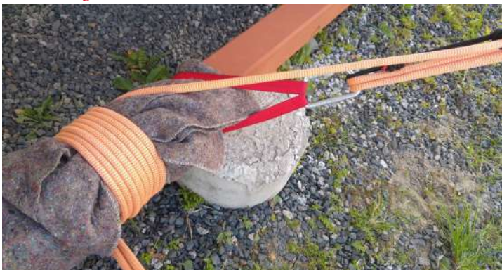
Figura 19. Arremate final com nó sem tensão
