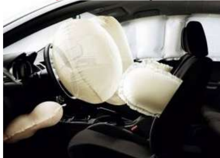
Figura 7 - Modelo de airbag lateral
