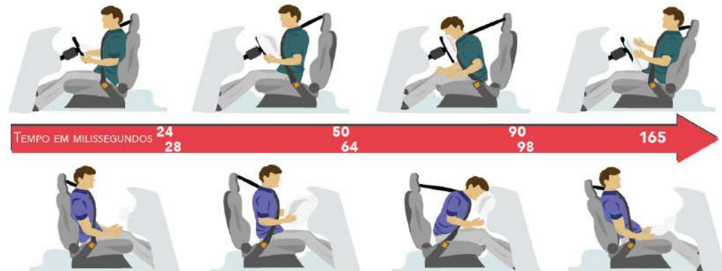
Figura 5 - Deflagração do airbag em relação à velocidade de colisão
