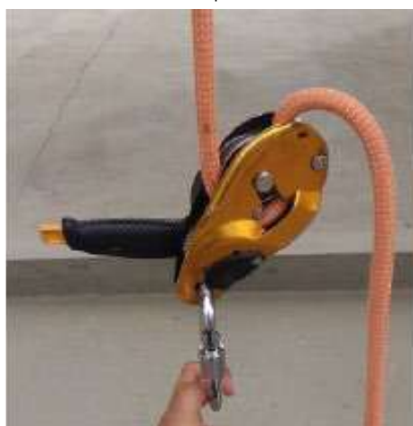
Figura 11. Instalação e posição do descensor ID
