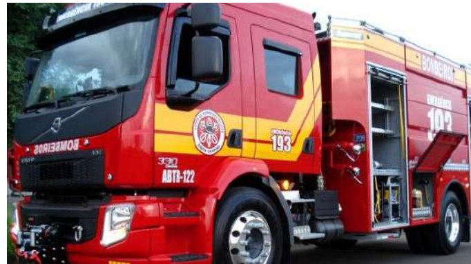
Figura 16 - Viatura com bombas de incêndio acopla-
