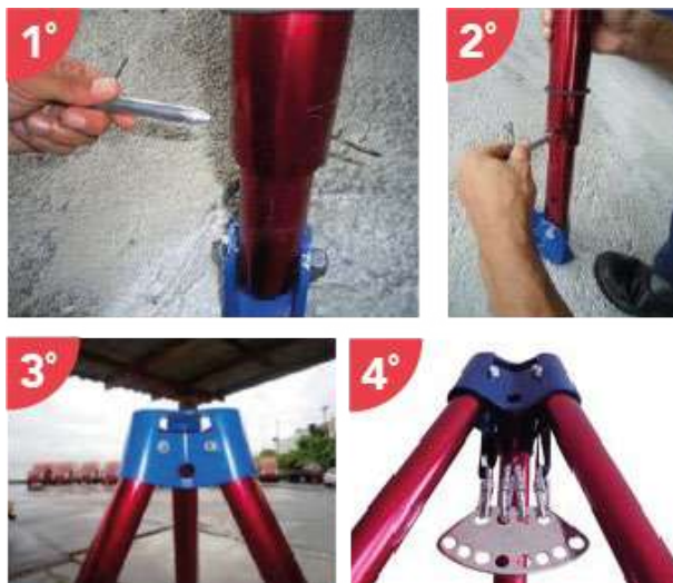
Figura 3. Sistema de articulação do tripé
