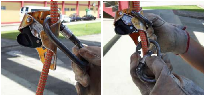
Figura 3. Travamento do ascensor
