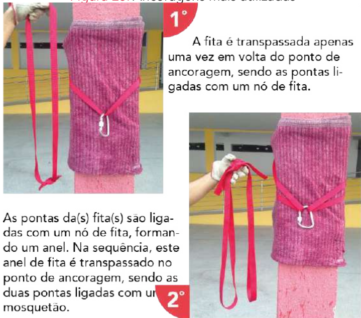
Figura 25. Ancoragens mais utilizadas
