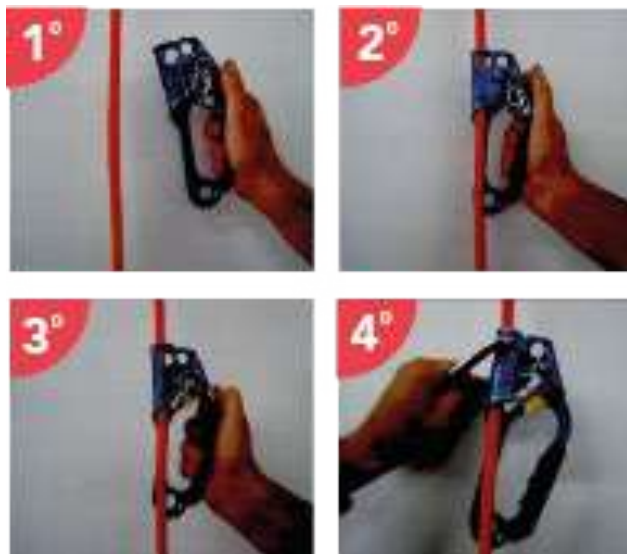
Figura 9. Sequência de instalação do ascensor de punho
