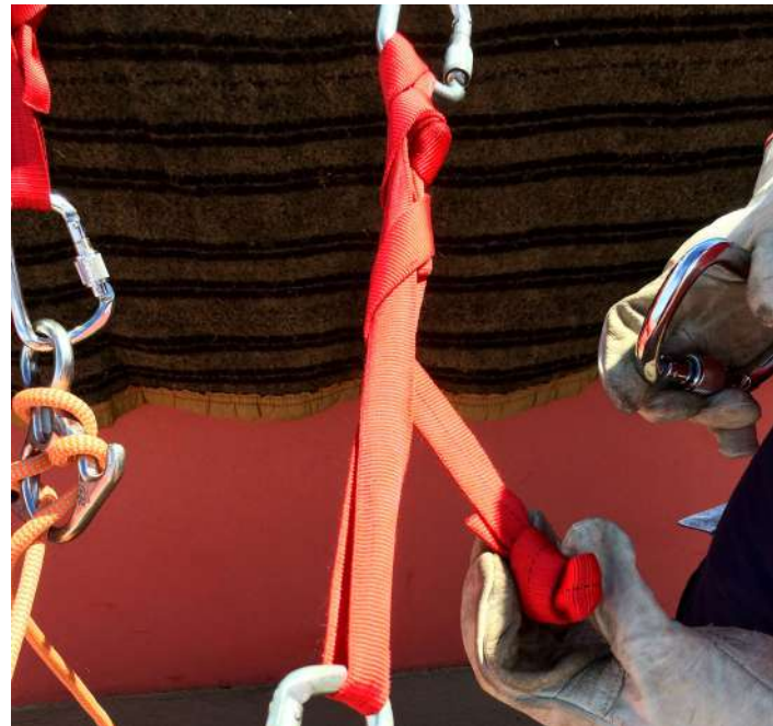
Figura 8. Liberação de carga usando SLC
