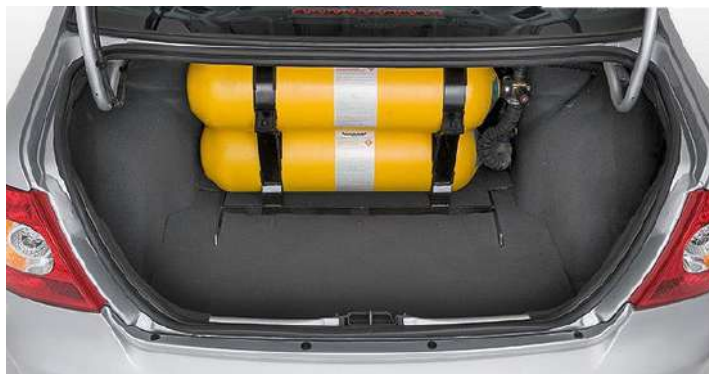
Figura 8 - Cilindro GNV instalado
