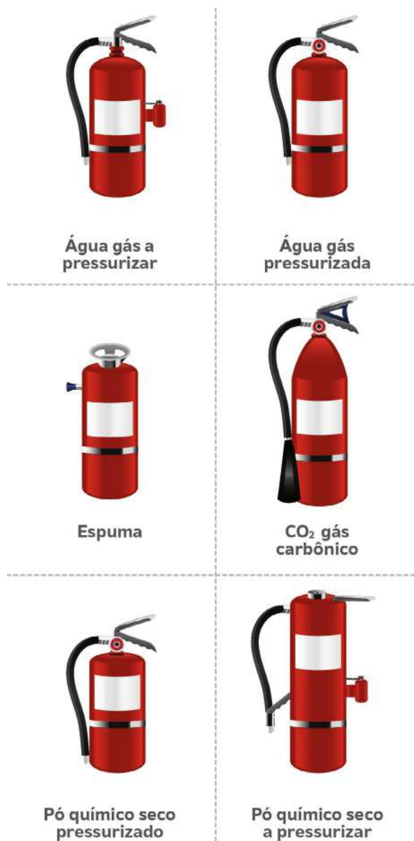
Figura 4 - Classificação dos extintores
