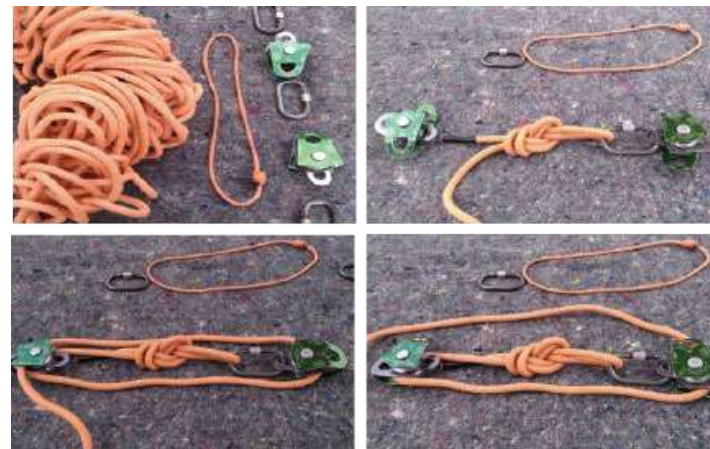
Figura 13. Sequencia de montagem de um sistema simples 4:1 estendido
