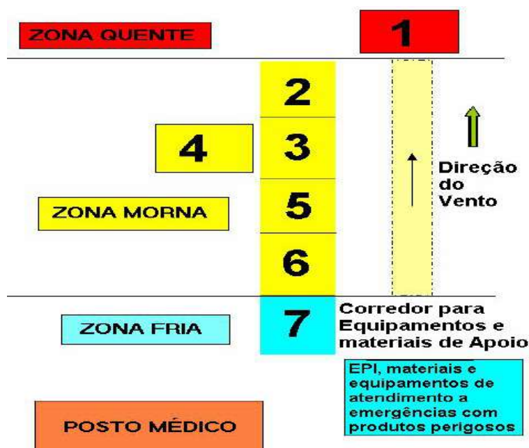
Figura 2 - Esquema do Corredor de Descontaminação
