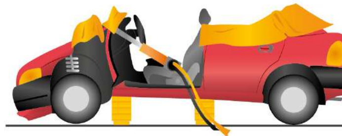
Figura 7 - Veículo com rebatimento do painel por manobra convencional
