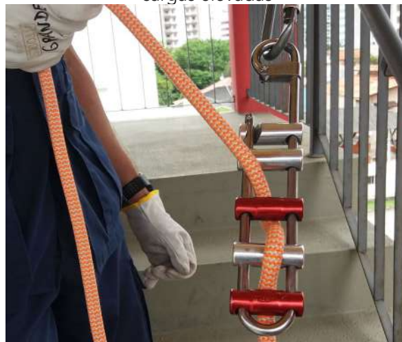
Figura 34. Sistema de frenagem com rack de barras para cargas elevadas
