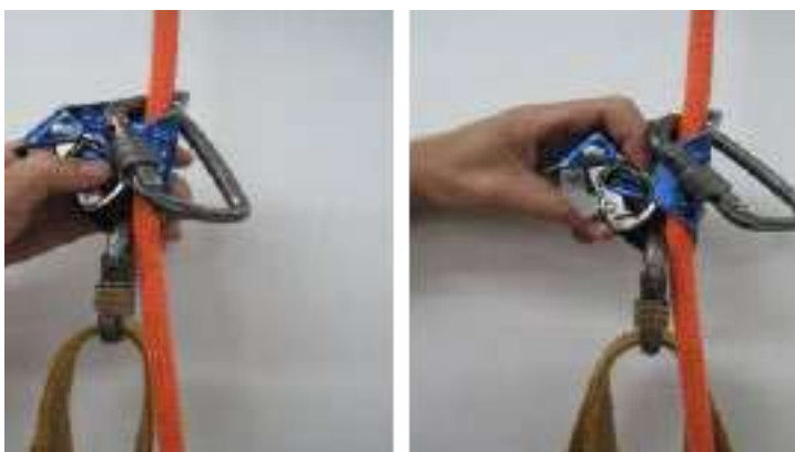
Figura 7. Liberação do ascensor ventral para a descida
