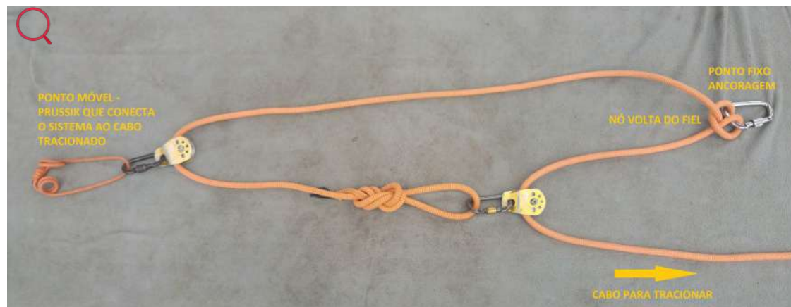
Figura 20. Sistema Pig Rig 4:1 com os dois subsistemas 2:1
