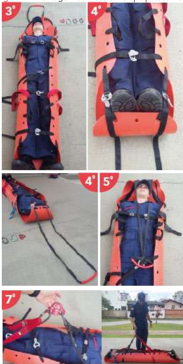
Figura 4. Montagem da maca envelope passos 4 a 7
