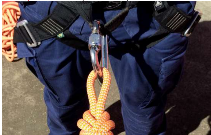
Figura 28. Colocação do mosquetão na cadeirinha
