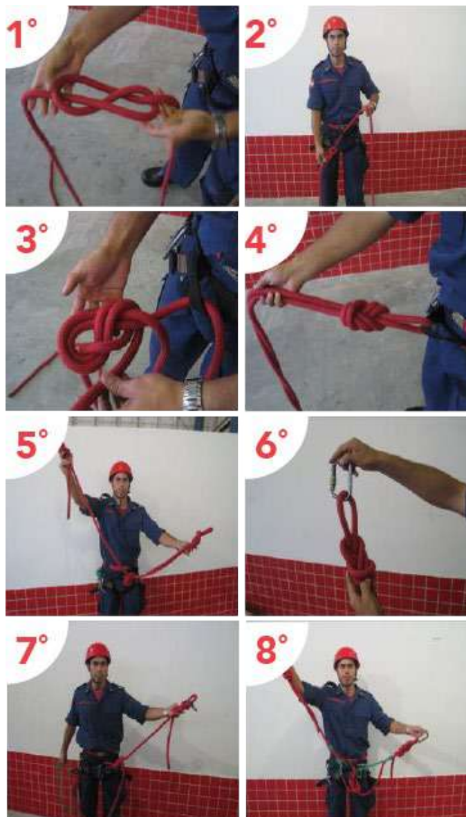
Figura 24. Confeção do talabarte em "Y" com o cabo da vida
