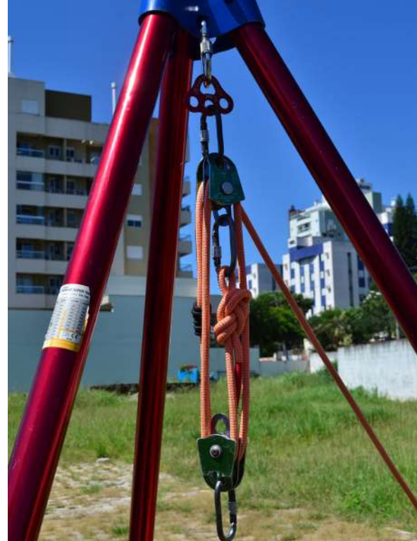
Figura 5. Sistema de multiplicação de força montado
