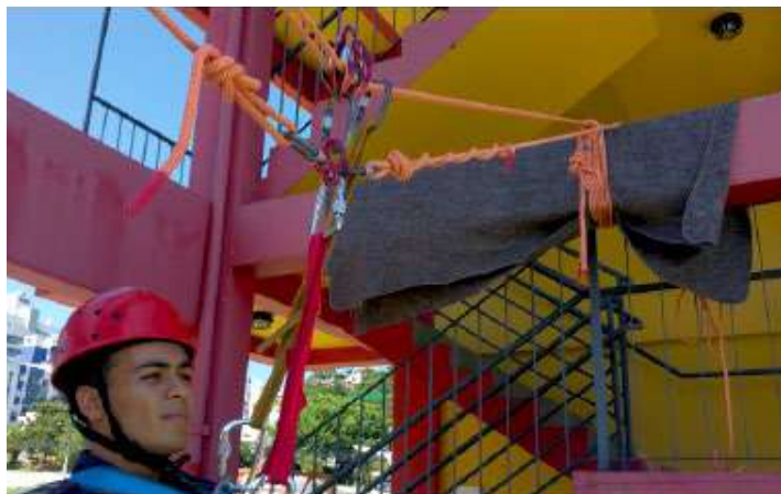
Figura 8. Sistema vai-e-vem mostrando a ancoragem da travessia
