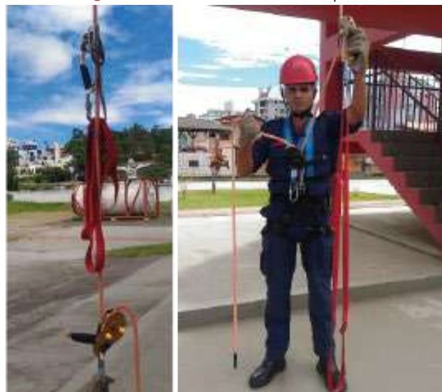
Figura 12. Sistema instalado e pronto
