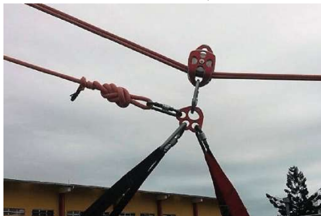
Figura 40. Detalhe da conexão na placa de ancoragem
