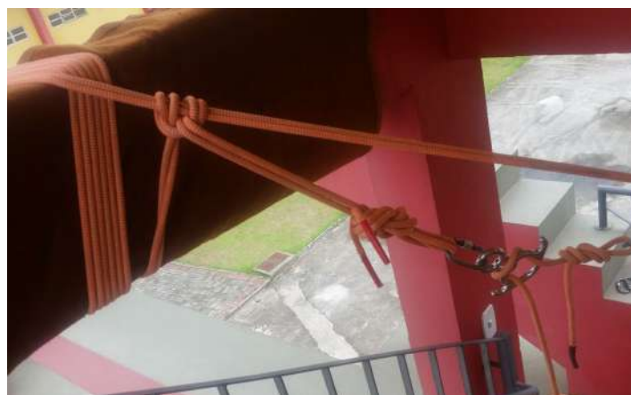
Figura 32. Sistema de frenagem com peça oito fixa
