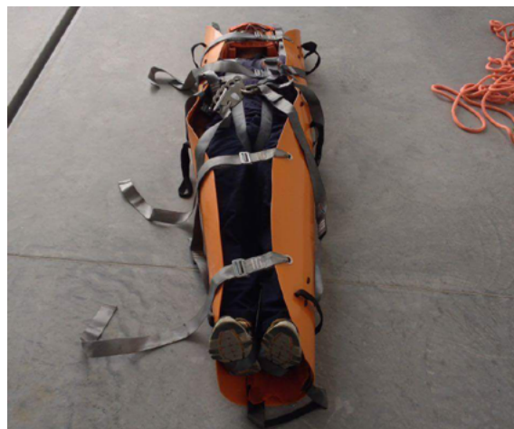
Figura 9. Maca pronta para transporte, com tirantes externos afivelados
