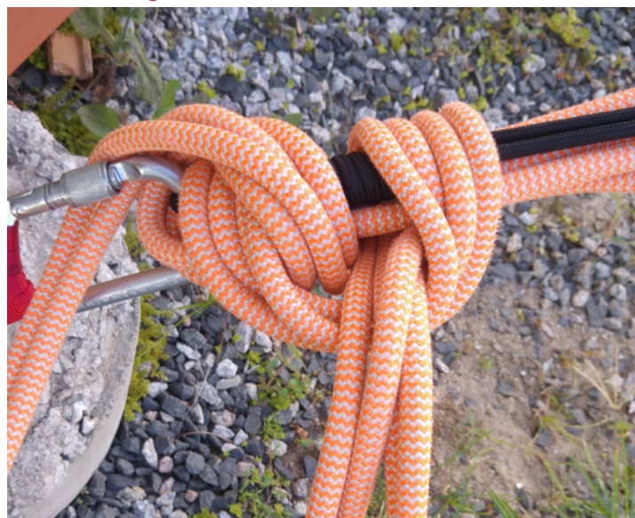
Figura 18. Arremate final volta do fiel
