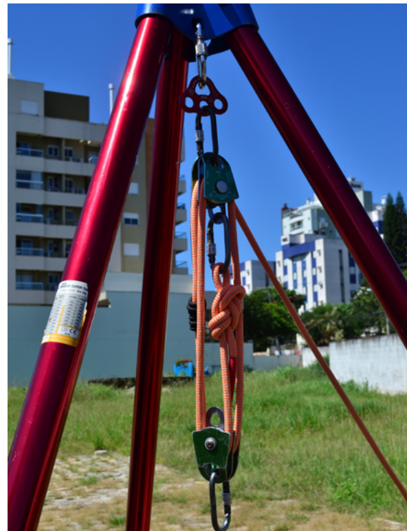
Figura 5. Sistema de multiplicação de força montado
