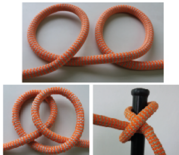
Figura 8. Execução do seio
