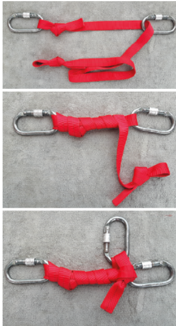
Figura 19. Sistema de liberação de cargas
