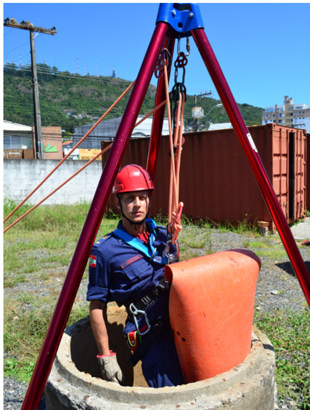
Figura 1. Tripé utilizado para resgate em poço
