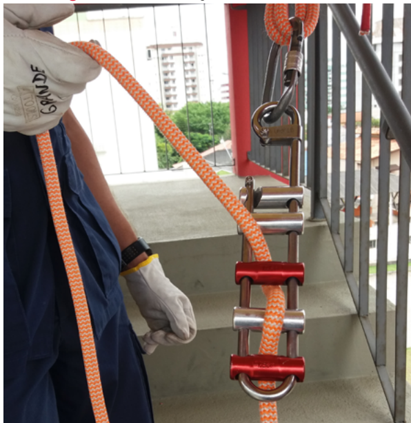
Figura 48. Colocação da corda no rack
