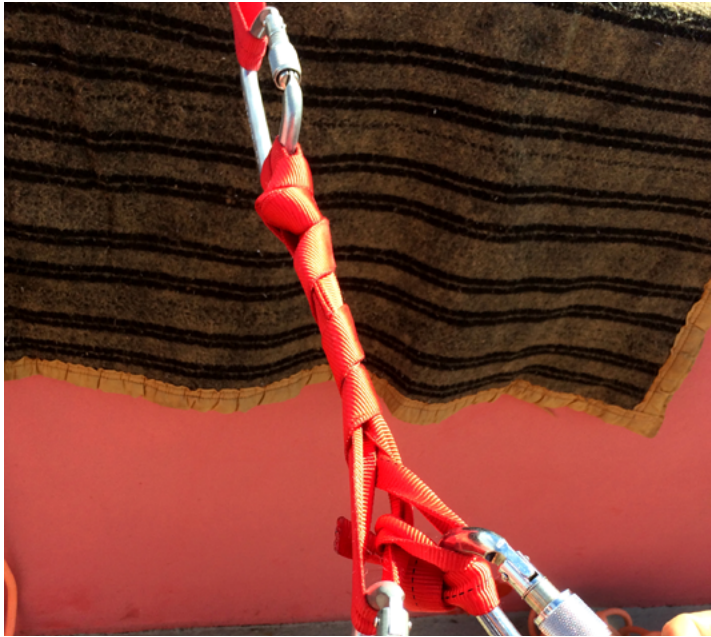
Figura 6. Sistema de liberação de carga
