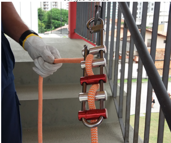
Figura 33. sistema de frenagem com rack de barras para cargas baixas
