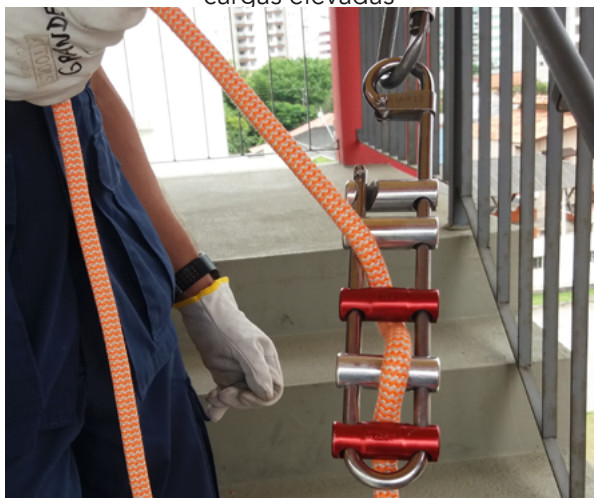
Figura 34. Sistema de frenagem com rack de barras para cargas elevadas
