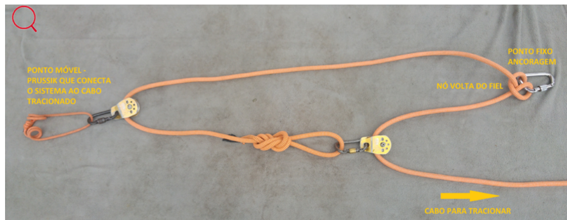
Figura 20. Sistema Pig Rig 4:1 com os dois subsistemas 2:1
