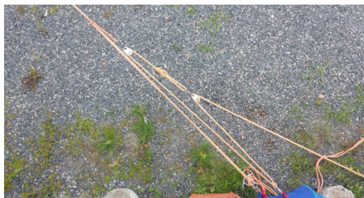
Figura 23. Vista superior do acoplamento do Pig Rig (à direita) no cabo da tirolesa
