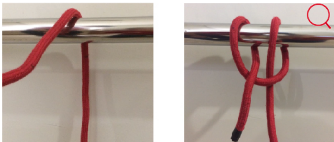
Figura 7. Execução do nó volta do fiel
