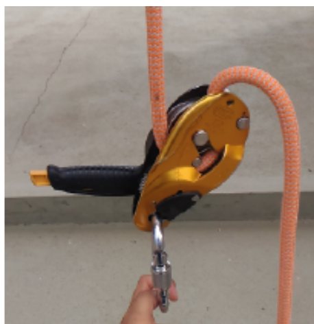
Figura 11. Instalação e posição do descensor ID
