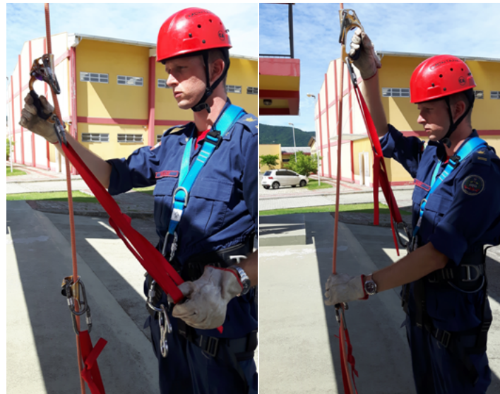
Figura 6. Mosquetão e fita fixados na base do ascensor superior e fita do ascensor superior presa a cadeirinha
