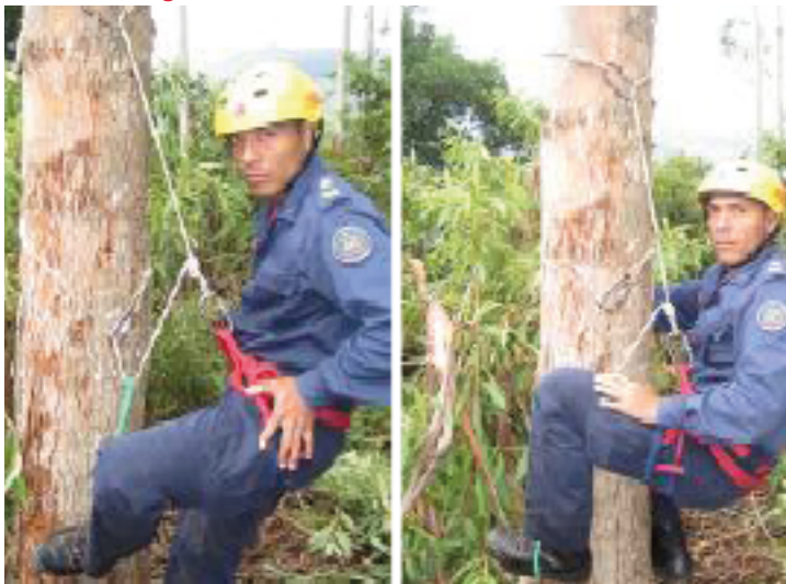
Figura 18. Sistema de subida em árvore
