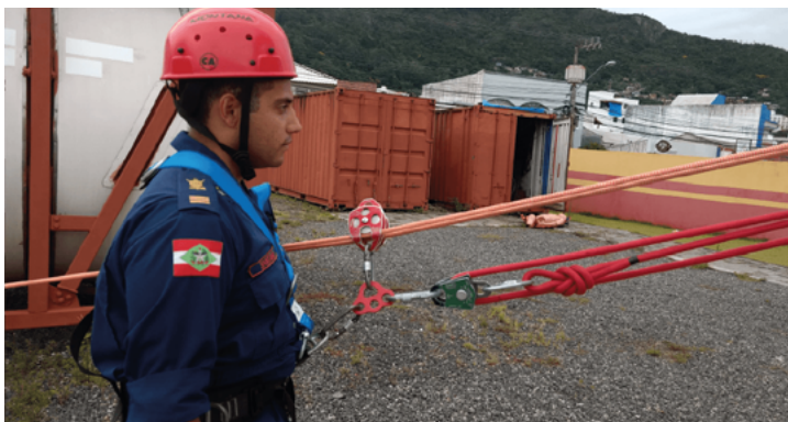
Figura 49. Ascensão de vítima sem maca utilizando sistema 3:1 estendido
