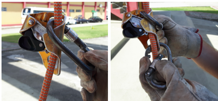
Figura 3. Travamento do ascensor
