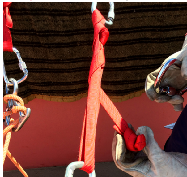
Figura 8. Liberação de Carga usando SLC
