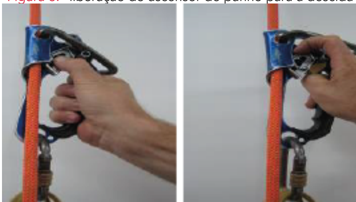
Figura 6. liberação do ascensor de punho para a descida
