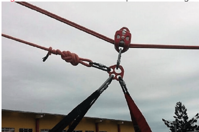
Figura 40. Detalhe da conexão na placa de ancoragem
