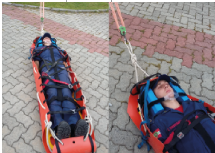
Figura 5. Cabo amarrando toda a parte superior da maca Envelope com nó tipo azelha em oito
