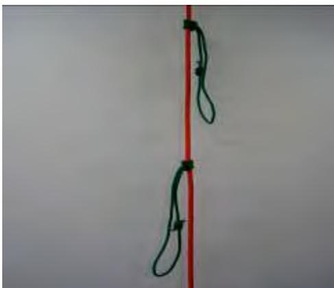
Figura 2.4 – Sistema com os prussiks montados
