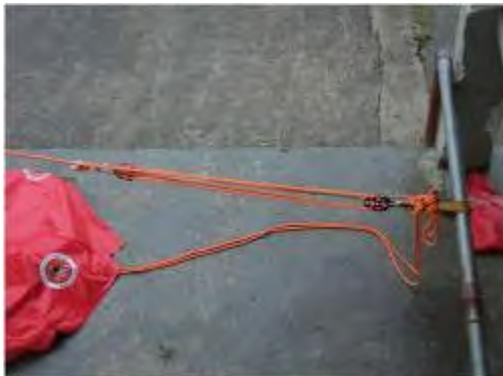
FIG 44 – Sistema carioca combinado utilizando polias em substituição a mosquetões
