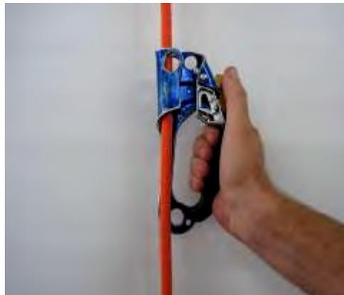
Figura 1.4 – Encaixe no cabo
