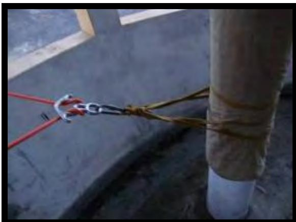
Foto 01 - Fixação do oito para controle da velocidade de descida
