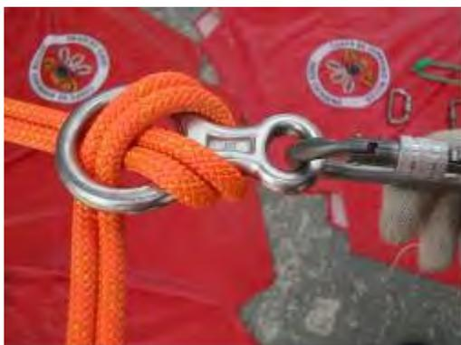
FIG 30 – Travar o freio oito e cuidar para que os cabos fiquem paralelos
