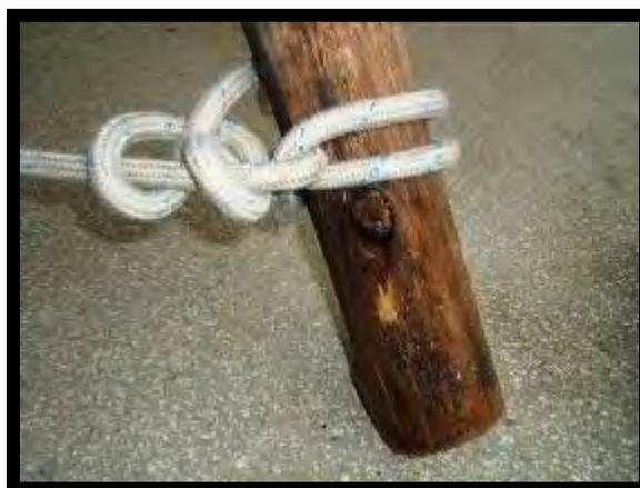
Figura 11 - Detalhe da volta do fiel com cote duplo na primeira haste
