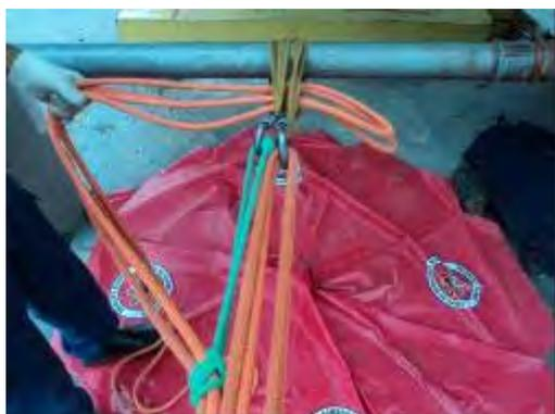
FIG 36 – A finalização do sistema é feita com dois cotes (volta do fiel) passando pelas fitas
