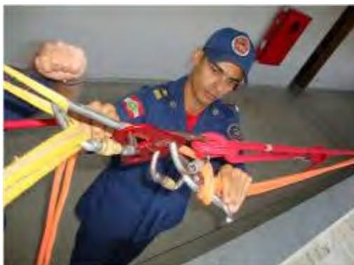
FIG 63 - Cabo tracionado – nova trava no freio oito
