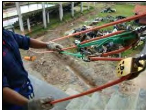
O cabo guia é liberado e o sistema de captura de progresso mantém o sistema travado. Então a polia móvel (mão esquerda do resgatista) é novamente deslocada em direção à vítima.
