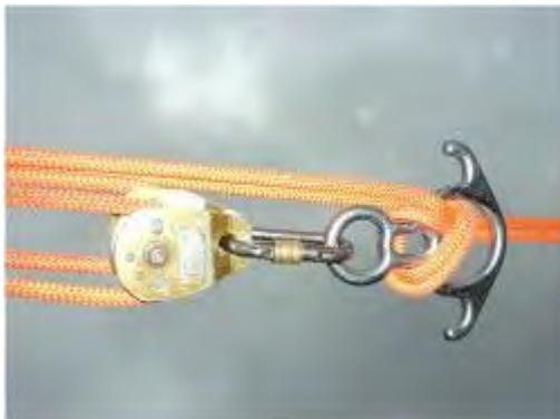
FIG 46 – Duas polias simples no sistema carioca combinado
