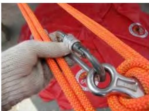
FIG 32– Cabos voltam paralelos por dentro do mosquetão que está no freio oito
