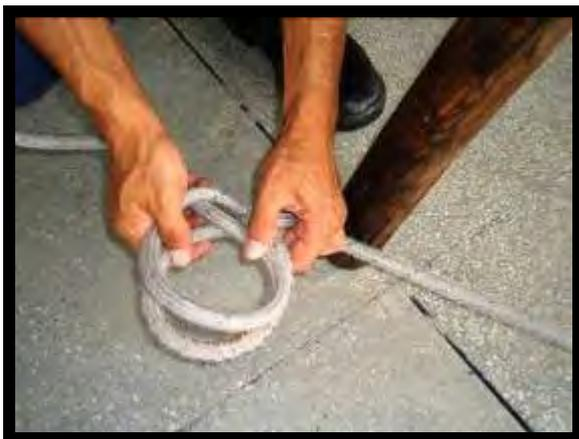
Figura 12 - Confeção da volta do fiel
