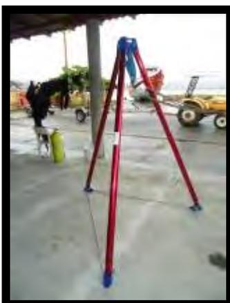
Figura 23 - Tripé montado
