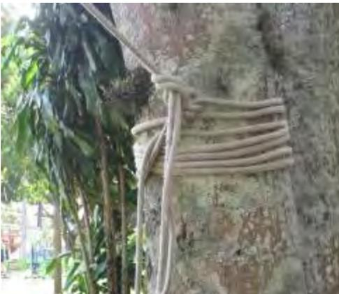
Figura 3.7 – Ancoragem em um ponto firme
