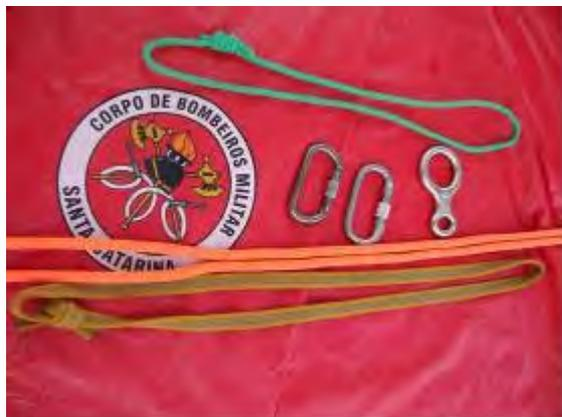
FIG 07 – Fita, cabo de salvamento, dois mosquetões, um freio oito e cordelete.
