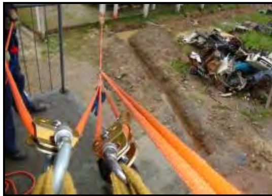
Vista do sistema de vantagem mecânica, utilizando sistema simples estendido (3:1).
