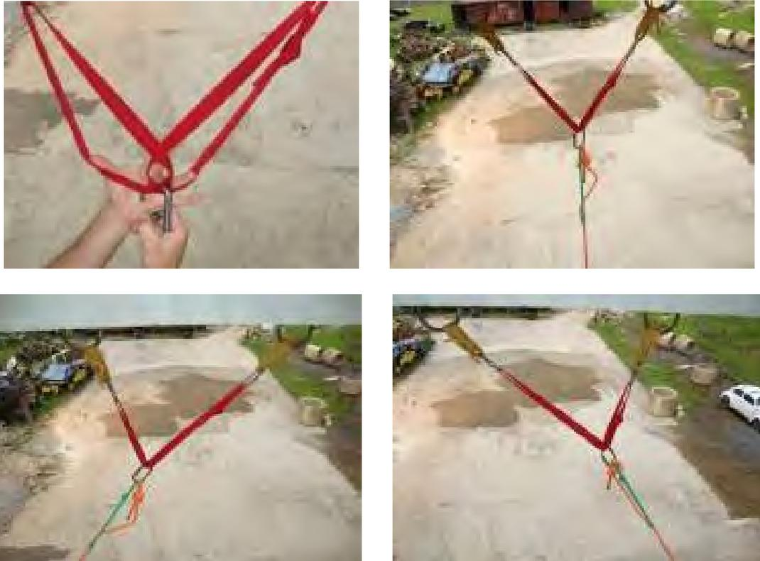
Figura 7: sistema de equalização auto-ajustável. Montagem e funcionamento.
