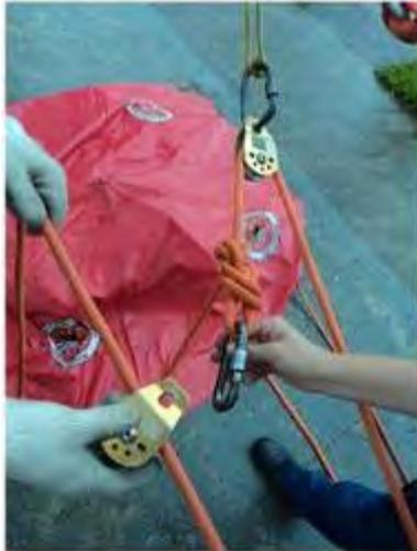
FIG 54 - Colocar uma polia simples no cabo que retorna da azelha do ponto fixo
