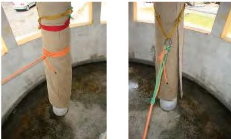
Figura 6: ancoragem em ponto bomba a esquerda utilizando voltas redondas, e a direita fita tubular, mosquetão e *prussik*.
