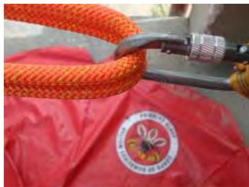
FIG 31 – Cabos passam por dentro do mosquetão do ponto fixo do sistema de força
