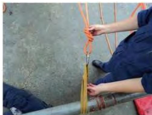
FIG 53 - Clipar em um mosquetão ancorado em um ponto fixo
