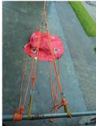
FIG 57 – Se necessário fixar com voltas redondas e finalizar com dois cotes
