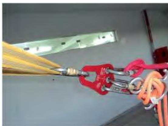
FIG 25 – Placa de ancoragem
