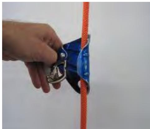
Figura 1.10 – Encaixe no cabo
