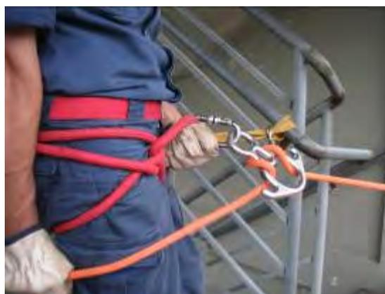
Figura 04 – Sistema de Freio com Oito e Ancoragem Humana
