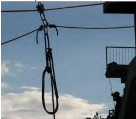
Figura 13 – Balso pelo seio pronto para operação.
