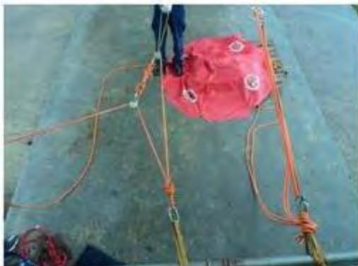
FIG 48 – Sistema independente de tração Pig Rig (4:1) – materiais: três mosquetões duas roldanas simples, cabo e cordelete
