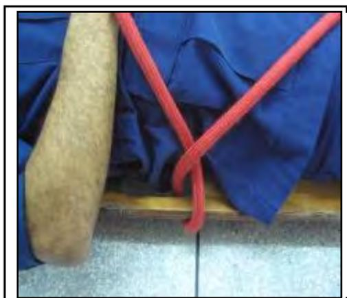
Figura 1.10 – Volta de ancoragem.
