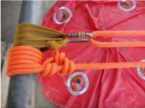
FIG 42 – Alternativa para falta do Prussik finalização com voltas redondas e dois cotes
