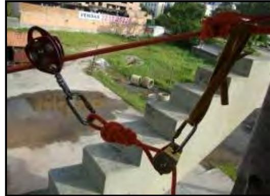
Passa uma fita dupla através do nó de ancoragem do sistema de tirolesa e clipe um mosquetão oval na mesma. Passe o cabo guia por uma roldana simples e clipe no mosquetão conectado a fita.
