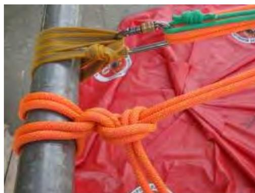
FIG 41 – Finalização com volta do fiel e dois cotes servindo com back-up
