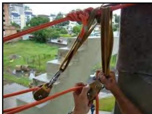
Novamente passe outra fita tubular dupla pelo nó de ancoragem do sistema de tirolesa. Passe a continuidade do cabo por mais uma roldana simples e conecte um mosquetão oval. Conecte o mosquetão da roldana na fita tubular dupla.
