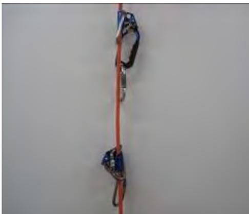
Figura 1.15 – Sistema de ascensores prontos
