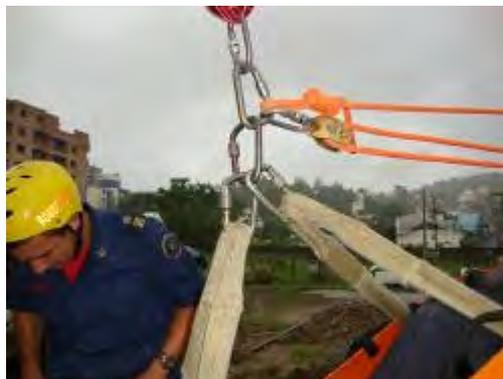
Vista das conexões onde a maca (sked) se encontra conectada ao sistema de tirolesa juntamente com sistema de vantagem mecânica. A maca esta pronta para ser içada.
