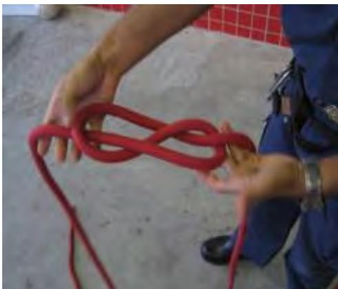
Figura 4.8 – Volta do fiador
