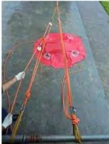
FIG 56 – Pig Rig (4:1) pronto para tracionar
