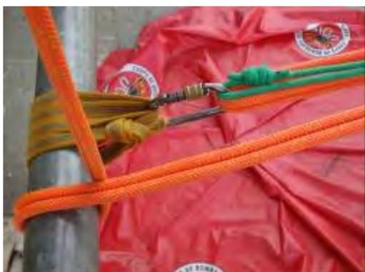
FIG 40 – Outra opção para finalizar o sistema é com um nó volta do fiel
