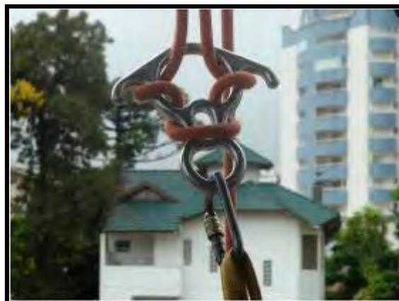
Fig. 16 – Oito duplo e ancoragem ao sistema.
