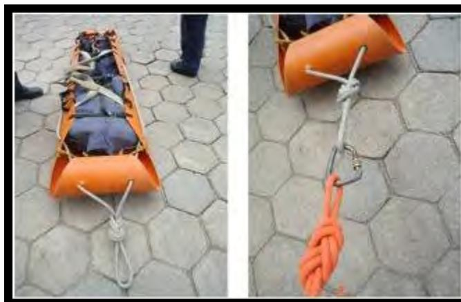
Foto 04 - Detalhe da fixação do mosquetão e azelha em oito
