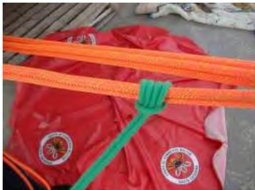
FIG 34 – Utilizar um Prussik para ajudar para ajudar na tração e segurança
