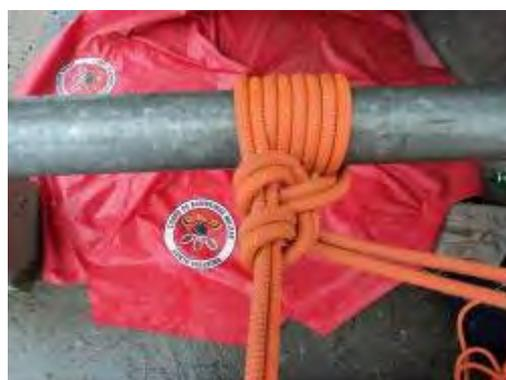
FIG 16 – Arremate com dois cotes ancoragem pronta
