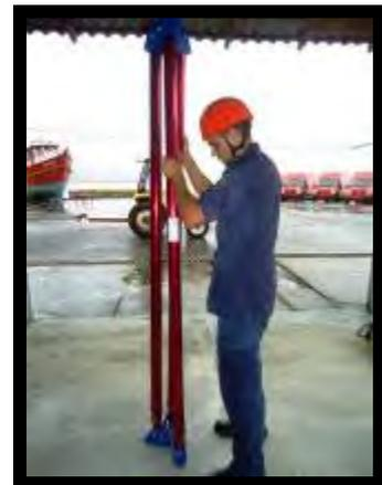
Figura 19 - Tripé na posição vertical
