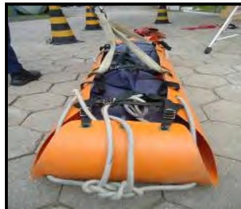
Figura 1.40 – Costura dos tirantes e nó “azelha em oito”. Figura 1.41 – Nó direito com dois cotes na parte inferior.
