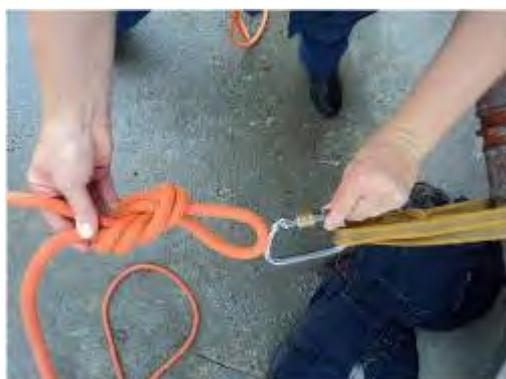
FIG 52 – Fazer um azelha em oito (ou volta do fiel – exemplo figura 60) no cabo que sai da polia
