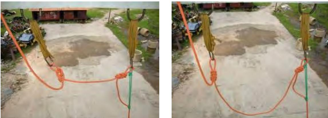
Figura 9: sistema de *back up*, utilizando fitas tubulares mosquetões e prussik. A esquerda, montagem correta (sem folga) e a direita, montagem incorreta.
