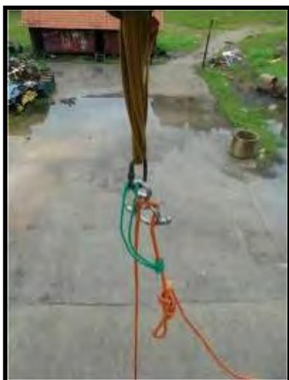
Fig. 42 – Nó nas duas extremidades do cabo.
