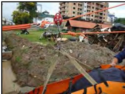
Vista das conexões onde a maca sked encontra-se conectada ao sistema de tirolesa juntamente com sistema de vantagem mecânica, utilizando sistema simples reduzido (3:1).
