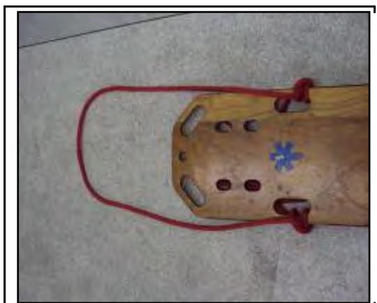
Figura 1.4 – Montagem da alça de ancoragem.
