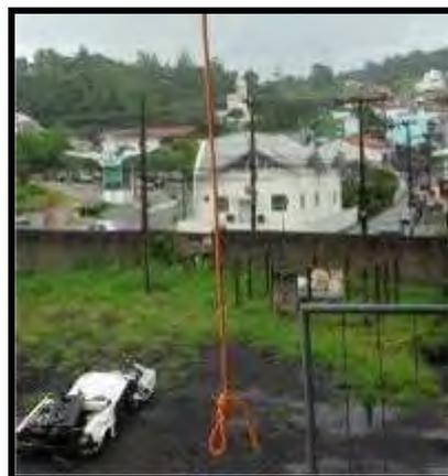
Fig. 32 – Azelha na extremidade do cabo.
