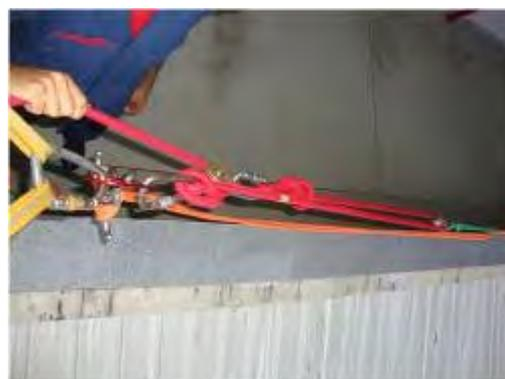
FIG 61 – Redução da tensão abaixo do cabo do Prussik
