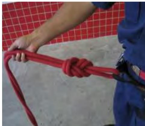
Figura 4.11 – Azelha em oito pela extremidade
