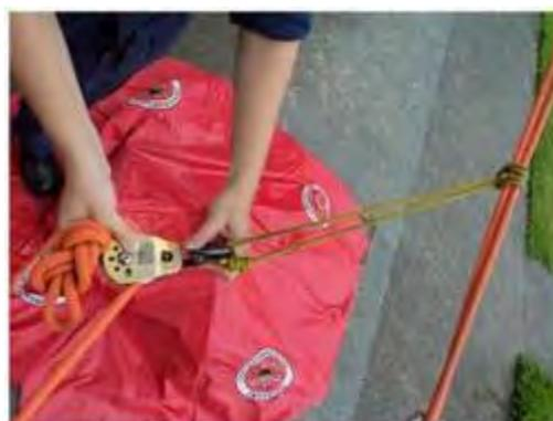
FIG 51 – Neste exemplo o prussik já está ligando o Pig Rig a linha de sustentação
