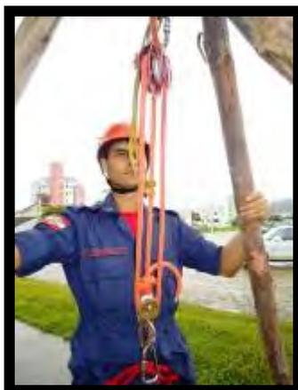
Figura 17 - Socorrista ligado ao sistema de multiplicação de força
