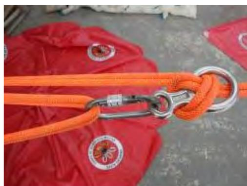
FIG 33– Cabos prontos para tracionar e iniciar o sistema de forças, neste caso 3:1
