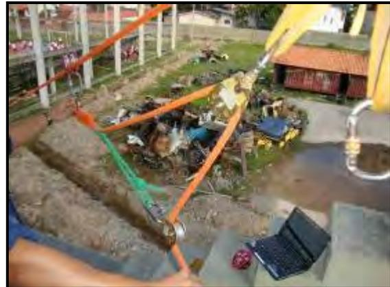
Com um cordelete faça um nó prussik no cabo que será diretamente ligado à vítima. Passe a continuidade do cabo guia por uma roldana simples. Conecte um mosquetão na outra extremidade do cordelete e na roldana.
