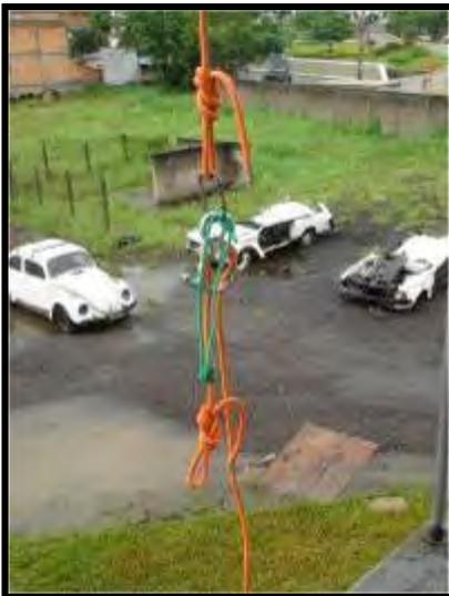
Fig. 35 – Sistema de segurança com cordelete e nó prussik.
