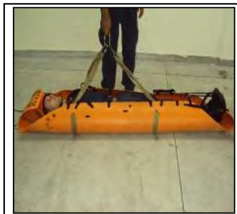
Figura 1.37 – Vista lateral da maca com alças de ancoragem.
