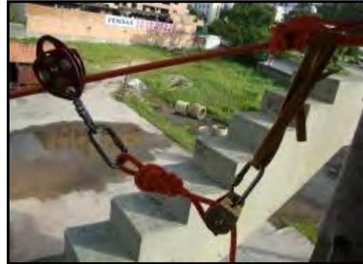
Passa uma fita dupla através do nó de ancoragem do sistema de tirolesa e clipe um mosquetão oval na mesma. Passa o cabo guia por uma roldana simples e clipe no mosquetão conectado a fita.
