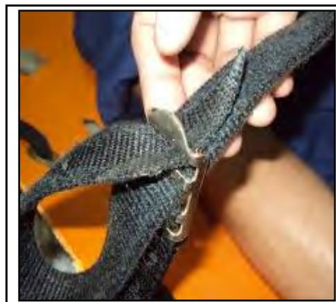
Figura 1.25 – Retorno pelo orifício superior da fivela.
