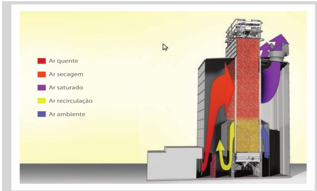
Foto 38 – Corte esquemático de um secador de cereais
