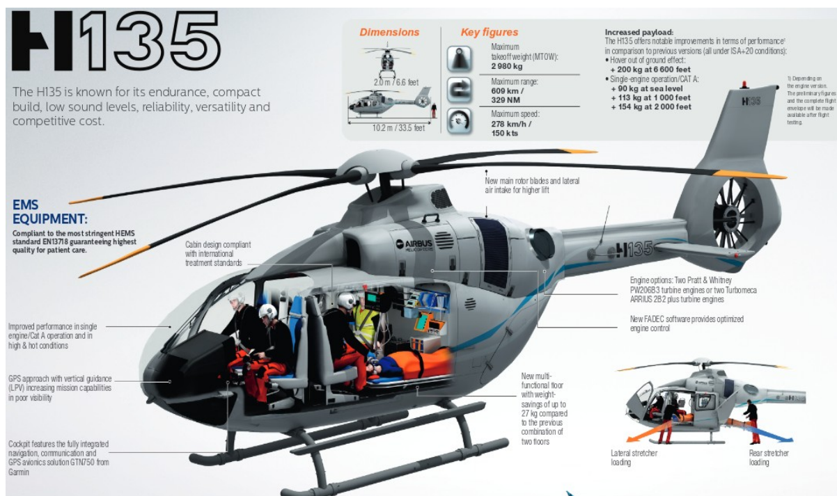
Figura 4: Helicóptero biturbina leve modelo H135 com configuração aeromédica.
