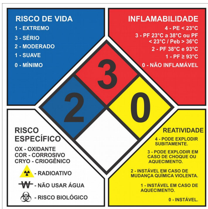
Figura 4 – Esquema da classificação de risco do diamante de Hommel
