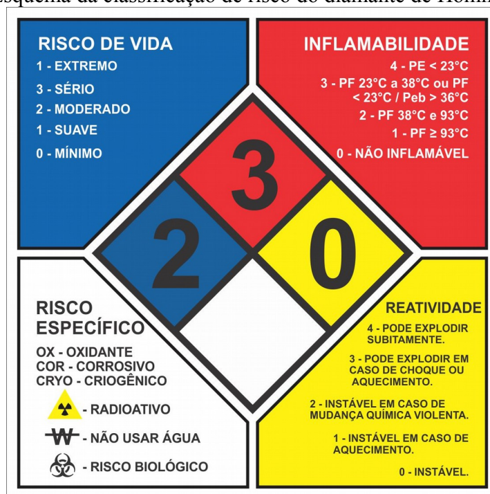
Esquema da classificação de risco do diamante de Hommel
