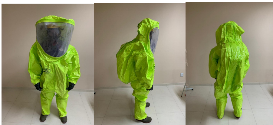
Figura 9 – Equipamento de Proteção Nível A
