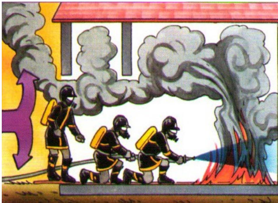
**Figura 07:** Em alguns locais não existe possibilidade de se efetuar a ventilação. Uma boa solução seria o uso de ventilação por pressão negativa.
