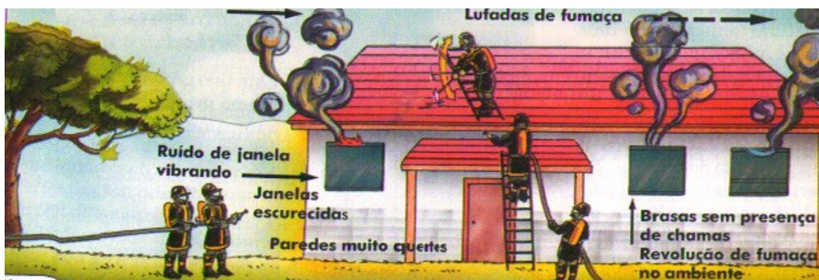
**Figura 06:** Ambiente pré-backdraft. Uma ventilação adequada diminui a possibilidade de ocorrência.
