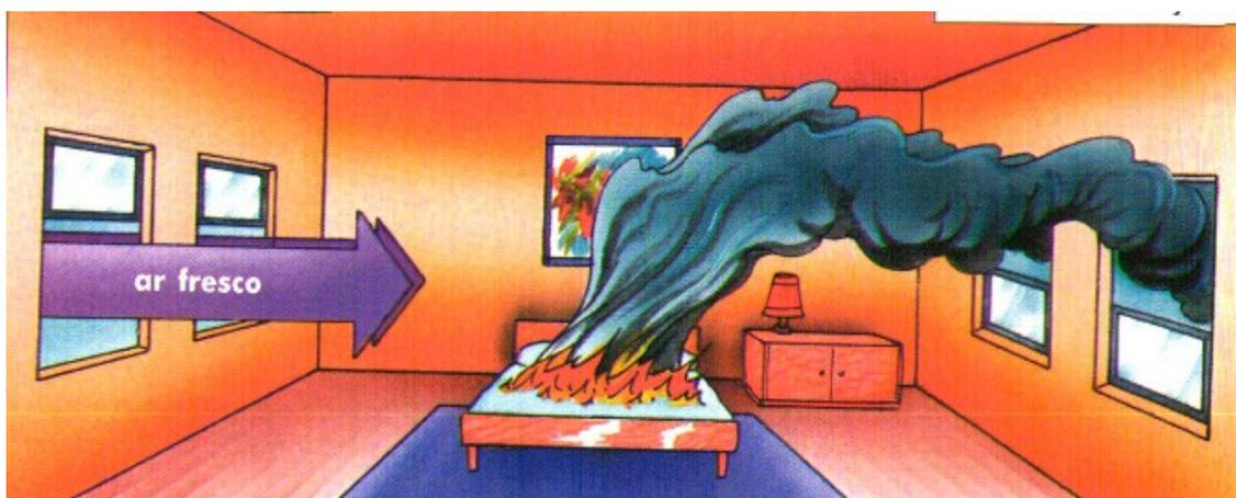
**Figura 01:** Ventilação horizontal. O fluxo de ar é ativado com duas aberturas, onde uma permite a entrada do ar fresco e outra a saída dos produtos da combustão. A abertura de entrada de ar deve ser a favor do vento.
