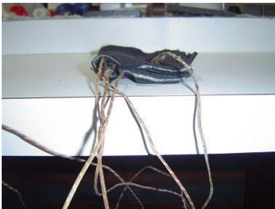
Foto 16 – Disposição dos termopares na roupa
