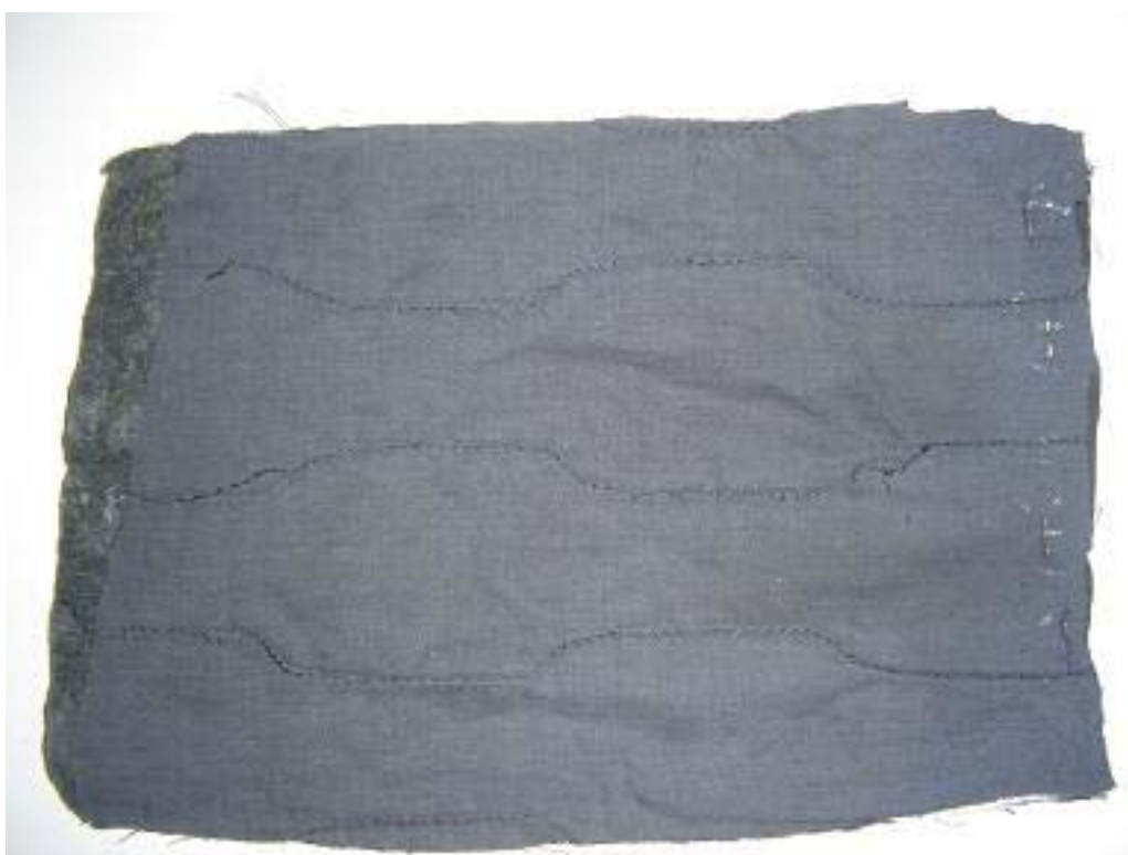
Foto 11 – Quarta camada da roupa de proteção de combate a incêndios Fonte: Do autor
