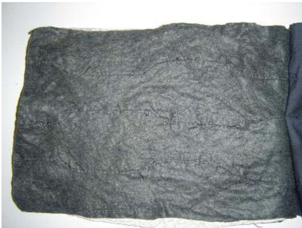
Foto 10 – Terceira camada da roupa de proteção de combate a incêndios Fonte: Do autor
