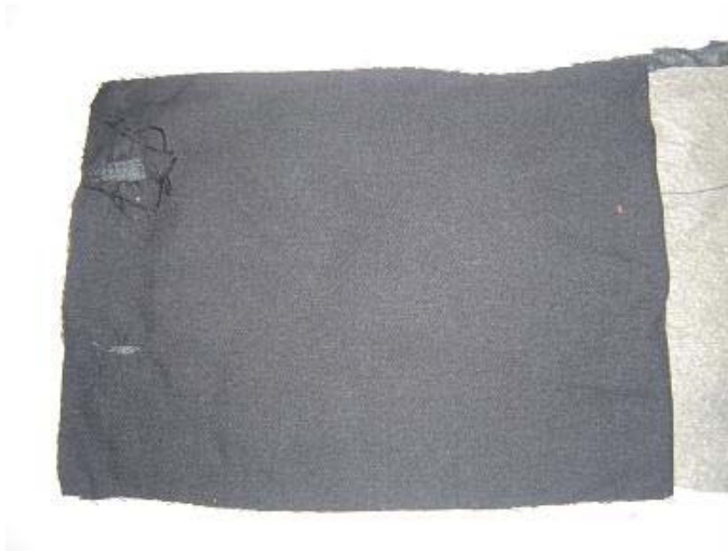
Foto 8 – Primeira camada da roupa de proteção de combate a incêndios
