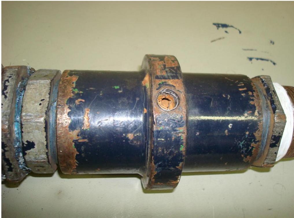
Anel piezométrico para tomada de dados e pressão
