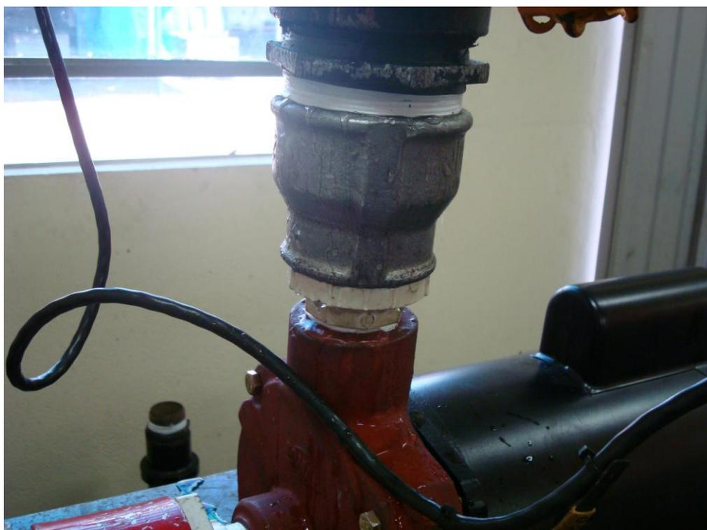
Adaptador de 2 ½" de aço galvanizado acoplado na bitola original da bomba
