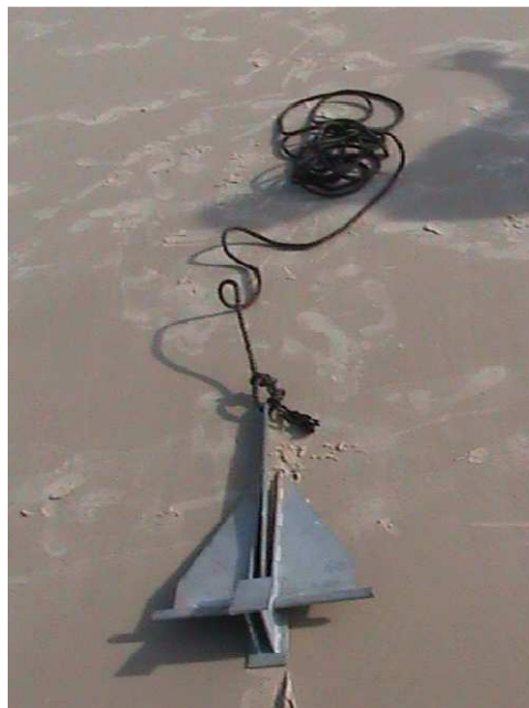
Figura 51 – Âncora utilizada na fixação das bóias do trabalho. Fonte: Do autor
