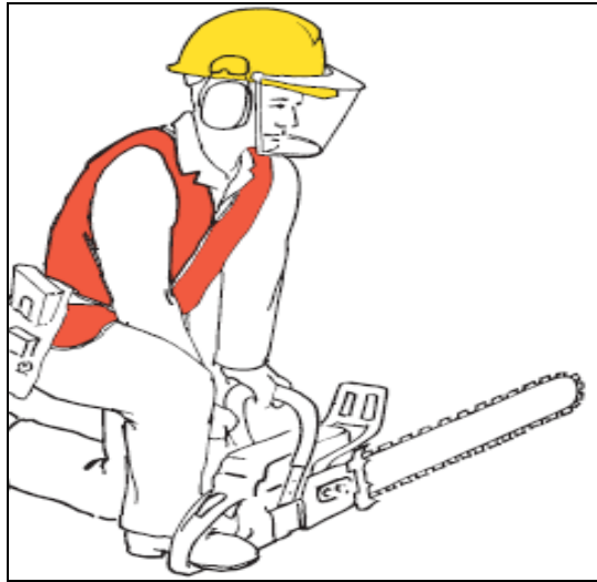
Figura 22 – Método seguro de iniciar o arranque da motosserra apoiada ao solo
