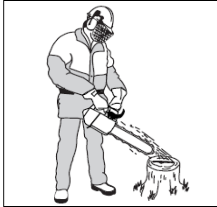
Figura 57 – Teste de lubrificação da corrente
