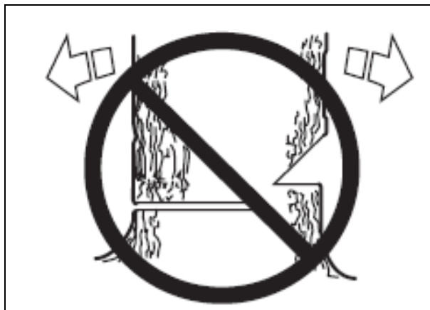
Figura 33 - Procedimento incorreto de corte (entalhe de abate abaixo do corte direcional)
