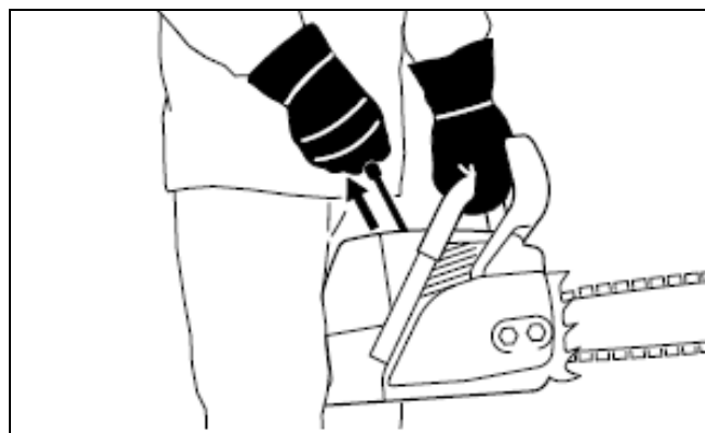
Figura 23 – Método seguro de iniciar o arranque da motosserra apoiado aos membros inferiores
