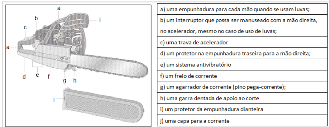
Figura 19 – Dispositivos de segurança nas motosserras sob a concepção da OIT
