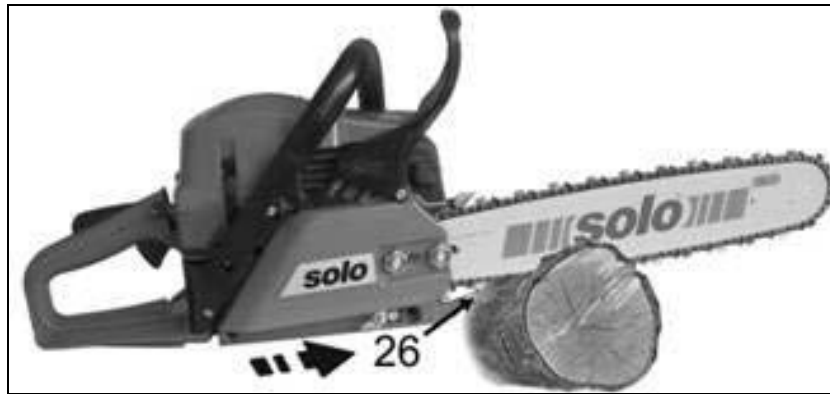
Figura 15 – Serrar com a corrente a puxar (método mais seguro)
