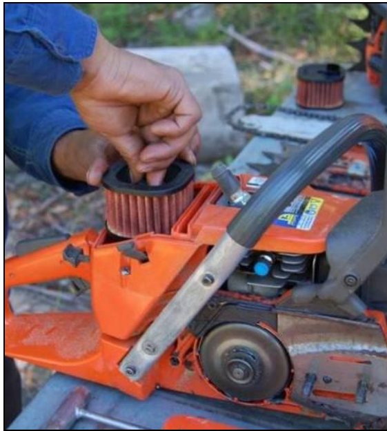
Figura 53 – Remoção do filtro de ar
