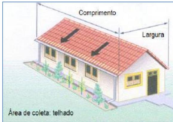
Figura 1: Superfície projetada da área de captação.
